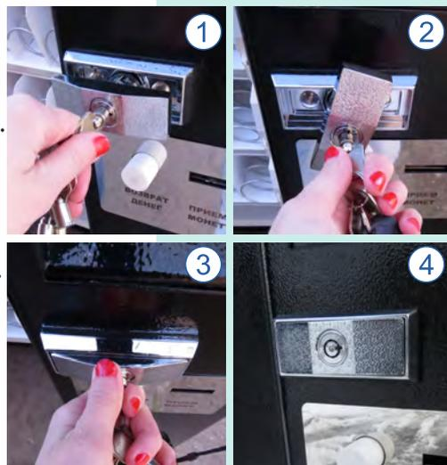
Фирменная система защиты, разработанная компанией «VendShop», надежно предохраняет торговый автомат от взлома. Сквозной антивандальный замок исключает возможность несанкционированного открытия. Замок изготовлен из хромированной стали, благодаря чему выдерживает различные погодные условия, что немаловажно при установке торгового автомата на улице.
